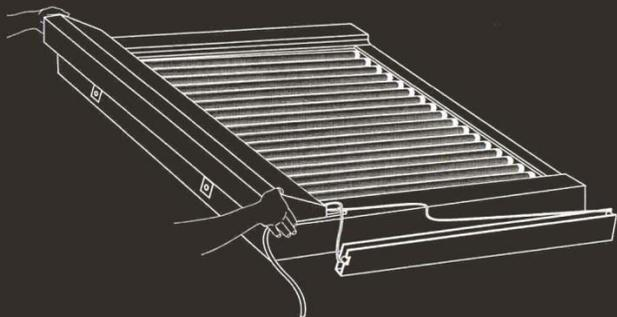
2. Fissare tramite rivetti o viti le cerniere posteriori del cassonetto sul collettore.
